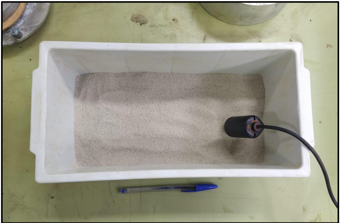
Figura 10: Experimento 4 - medição de umidade de areia com o sensor TEROs 12.
