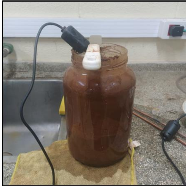
Figura 7: Mistura de água com o rejeito Abóboras para testagem com sensor TEROs 12.
