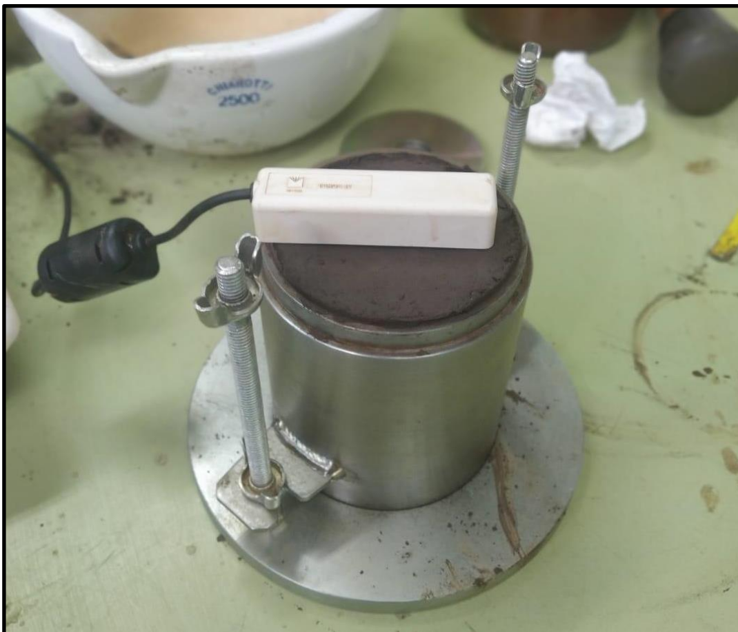
Figura 9: Experimento 3 - medição de umidade do rejeito Abóboras com a cravação das hastes do sensor TEROS 12.
